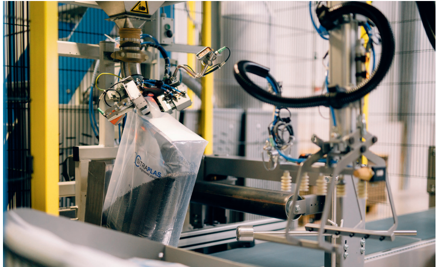
Bild 1. Nach dem Befüllen werden die Säcke umgeworfen, ausgerichtet und gewalzt
